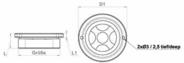
Die neuartige Konstruktion ermöglicht Anzugsdrehmomente, wie sie nur bei Sechskant zu erreichen sind. Zusätzlich wurde das Sichtfeld um 20% vergrößert. Durch den Einsatz eines 3 mm dicken Glases, wird die Sicherheit deutlich erhöht. Betriebsdruck bis 4 bar, max. Temperatur 130 °C. Material: Messing. Andere Ausführungen oder spezielle Dichtung (Viton) auf Anfrage.
