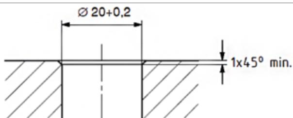
Aufnahmebohrung für Entlüfstopsfen
