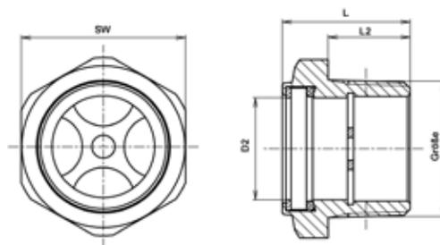
Schaugläser, die auch als Ölstandsaugen bekannt sind, gewähren dank der großen Sichtfenster Einblick ins Innere von Fluidbehältern, Getriebegehäusen und Fluiddurchleitungskörper in Form eines Rohres, um darin Flüssigkeitsstände oder Betriebsituationen erkennen und ablesen zu können.
