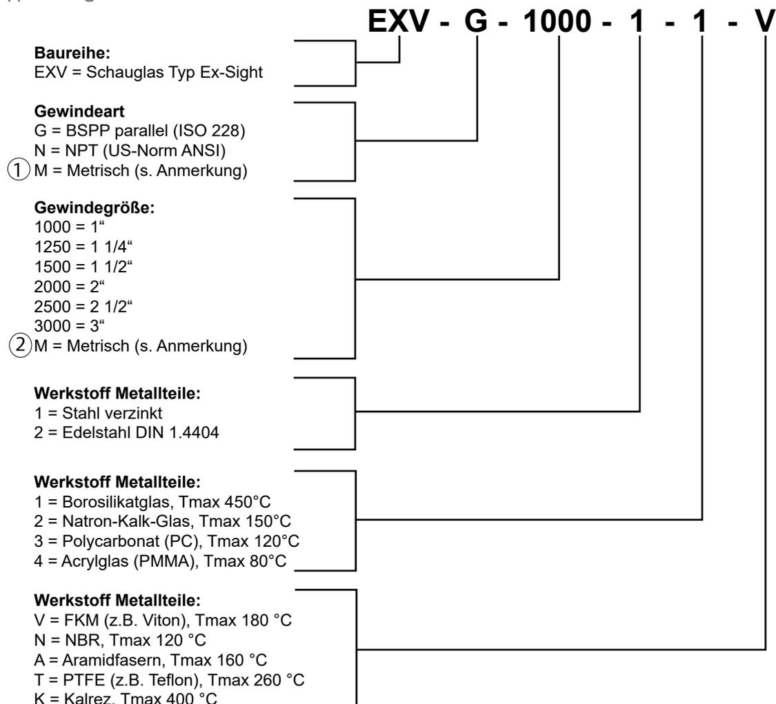
① Wegen der Vielfalt der Möglichkeiten werden diese Ausführungen nur auf Bestellung gefertigt. Technische Details sind den jeweiligen Auftragsunterlagen zu entnehmen.
