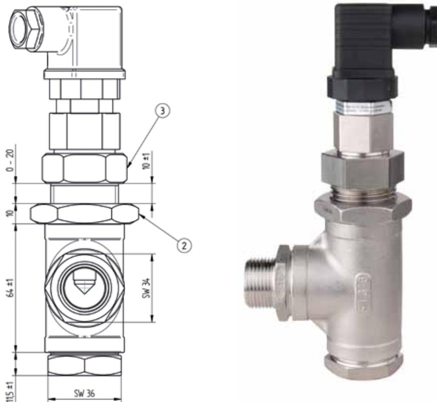
Der Sensor ist bereits vormontiert in der Einstellvorrichtung. Er kann noch um max. 10 mm abgesenkt werden, ausgehend von der Mittellinie des Anschlusses.
