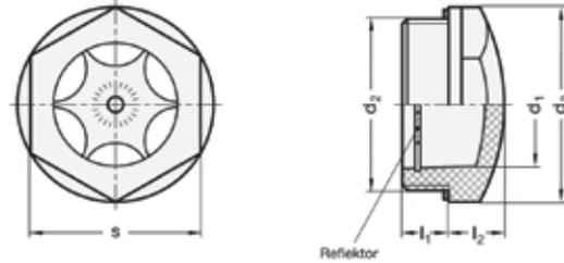
Ölstandsaugen aus transparentem Polyamid (PA-T) haben eine hohe mechanische Festigkeit. Deswegen sind sie verhältnismäßig dünnwandig ausgeführt, mit großer Schauöffnung. Lösungsmittelbeständig, jedoch nicht alkoholbeständig. Die Lieferung kann mit oder ohne Reflektor erfolgen. Kunststoff aus glasklarem Polyamid (PA-T), Reflektor aus Aluminium eloxiert, Dichtung aus NBR. Temperaturbeständig bis 100 °C.
