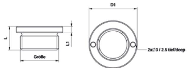
Die neuartige Konstruktion ermöglicht Anzugsdrehmomente, wie sie nur bei Sechskant zu erreichen sind. Zusätzlich wurde das Sichtfeld um 20% vergrößert. Durch den Einsatz eines 3 mm dicken Glases, wird die Sicherheit deutlich erhöht. Betriebsdruck bis 4 bar, max. Temperatur 130 °C. Konstruktion gemäß der ATEX-Richtlinie DIN EN 13463-1. Fallweise Prüfung von lichtdurchlässigen Bauteilen bei Verwendung im Ex-Bereich.
